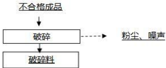
图 2-4 现有项目不合格品破碎生产工艺流程图及产污环节
