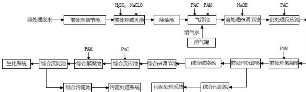
图 3.3-5 前处理废水预处理工艺流程图
