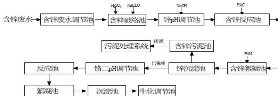
图 3.3-6 含锌废水预处理工艺流程图
