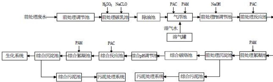
图 2.4-5 前处理废水预处理工艺流程图
