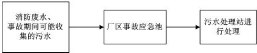
图 8.8.6-1 事故废水收集处理体系图
