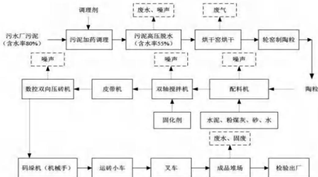
图 2-2 现有项目生产工艺流程图及产污环节
