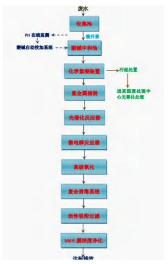
图 4.1-1 实验室自建污水处理厂流程图
