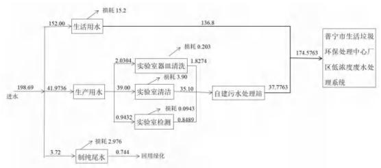
图 3.4.3-1 项目水平衡图 (单位: t/a)
