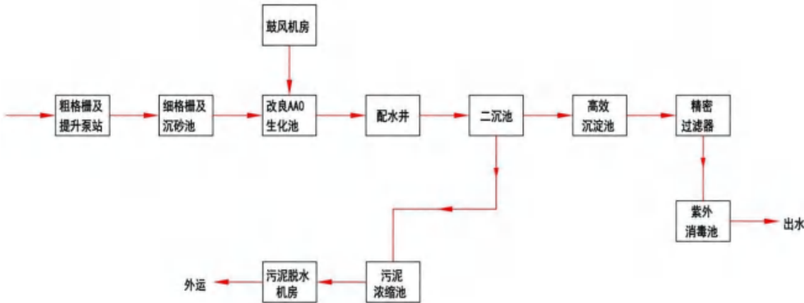
图 4-3 污水处理工艺流程图
