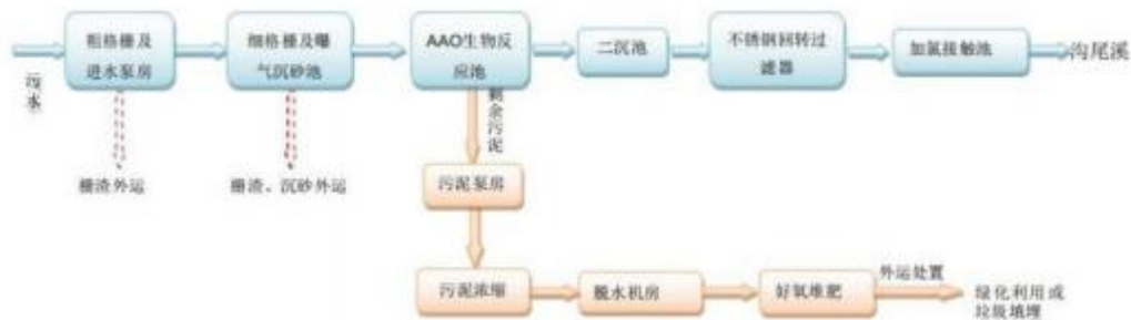
图 4-1 潮州市第二污水处理厂工艺流程图
