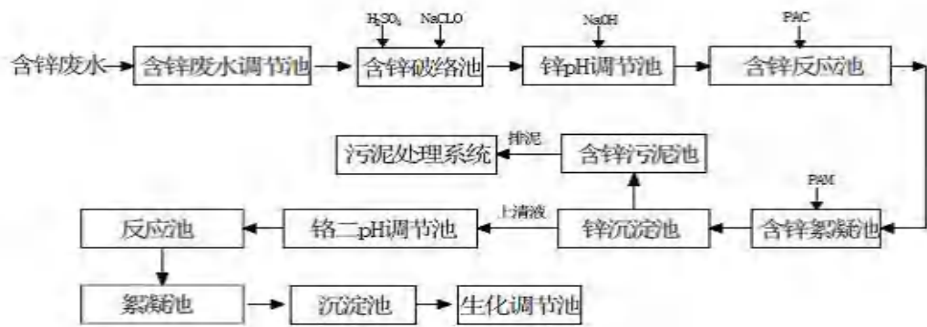
图 7.1-2 含锌废水预处理工艺流程图
