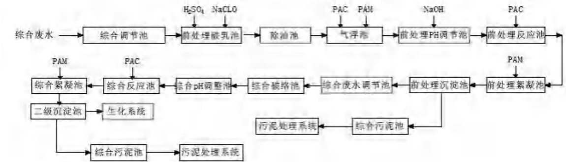
图 7.1-7 综合废水预处理工艺流程图
