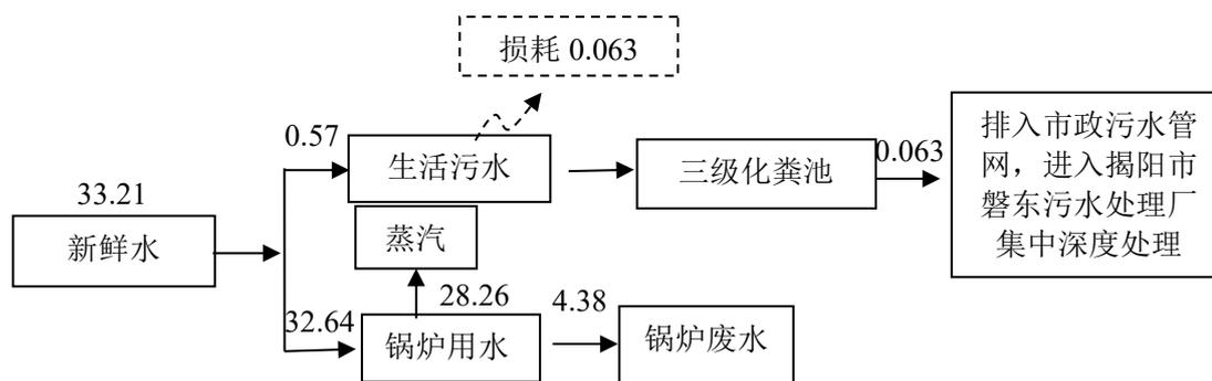
图 1-1 项目水平衡图 单位 t/d
