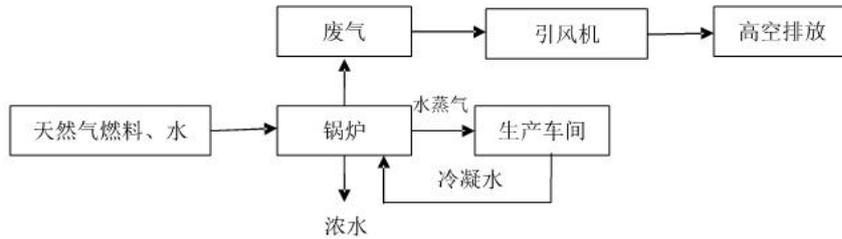
图 2-1 天然气锅炉工艺流程及产污环节图
