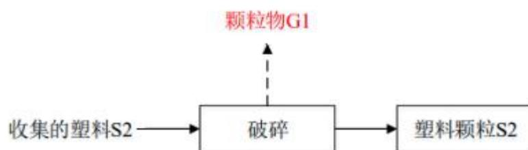
图 2-11 塑料破碎工艺流程图
