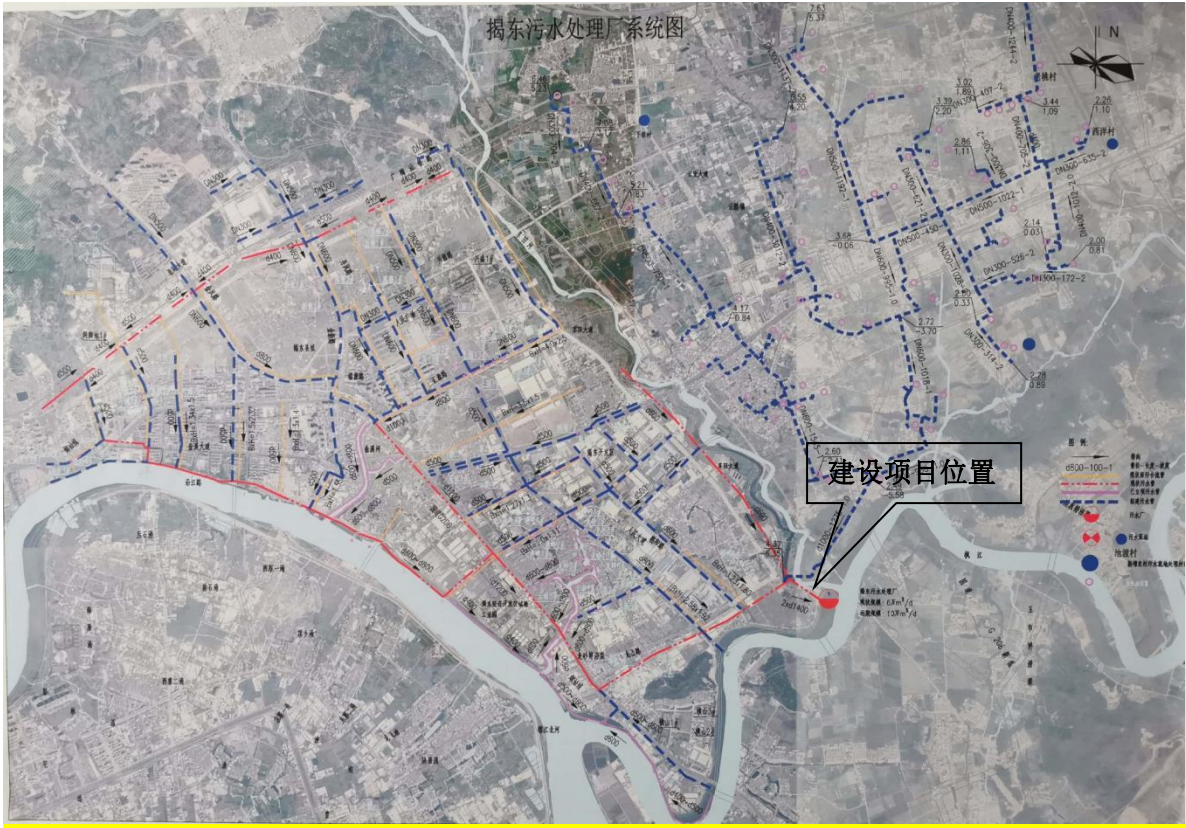
图6.2.2-1 污水处理厂污水管网分布图
