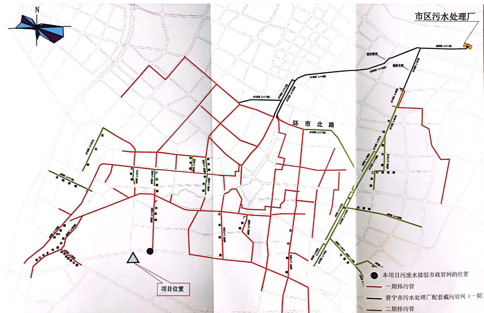
图6.2-2 普宁市市区污水处理厂纳污管网图
