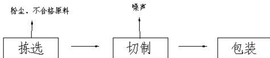
图 2-8 淡竹叶中药饮片生产工艺流程图
