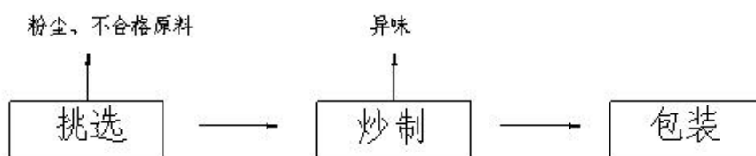
图 2-3 白扁豆中药饮片生产工艺流程图
